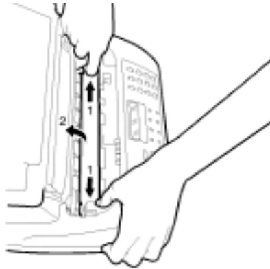
Afbeelding 23: Scherm van de scanner kantelen.
