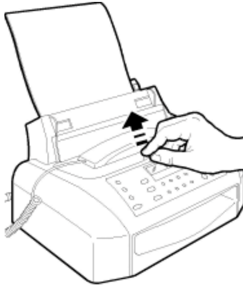
Afbeelding 4: Binnenwerk fax openen.
